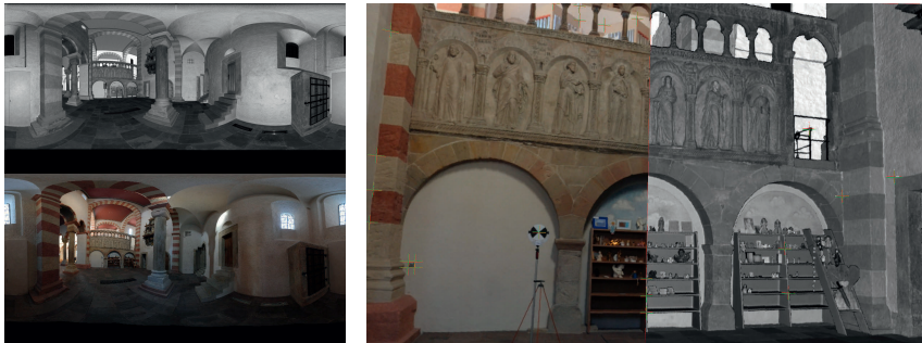
Abb. 2: Links oben: Aus einem Rundumschweifen (PTG-Format) abgeleitetes Remissionspanorama. Links unten: Mit PTGui Pro aus dem Photosatz der Abb. 1 berechnetes Photopanorama. Rechts: Gemeinsame Darstellung von referenziertem Remissions- und Photopanorama in der Software 3D-Panorama-Viewer (gemessene Passpunkte sind mit roten und grünen Kreuzen markiert).
