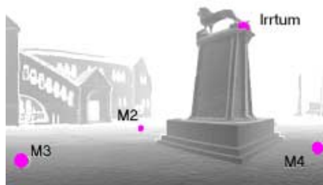
(c) Automatisch erkannte Passkugeln im Scan 3.
