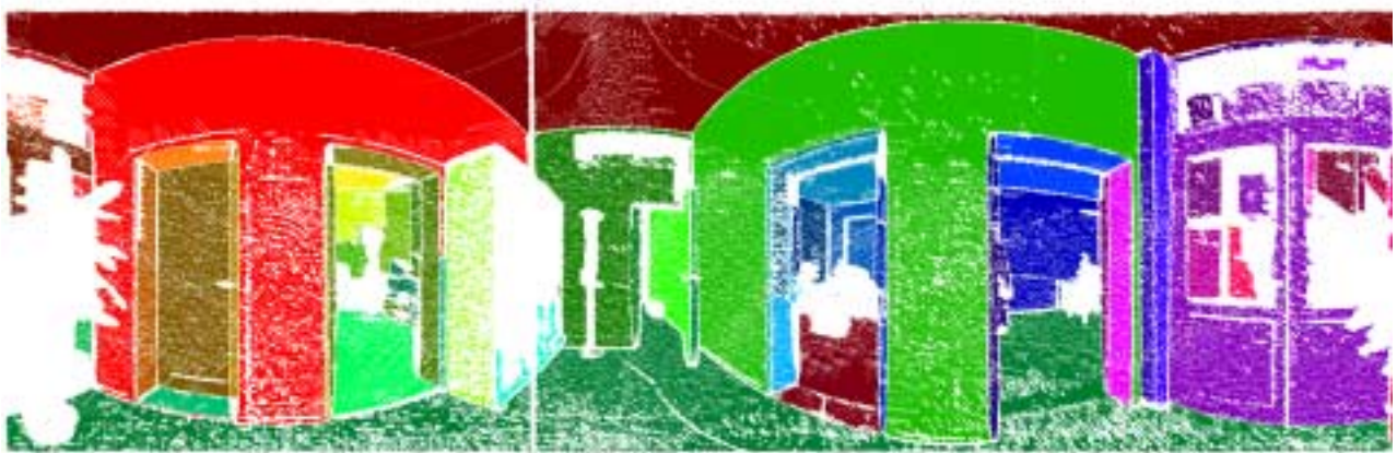
(b) Segmentierung nach 30-facher Anwendung des Mittwertfilters ( \alpha_{n,tol} = 40 gon, n_{t,min} = 1000 ).
