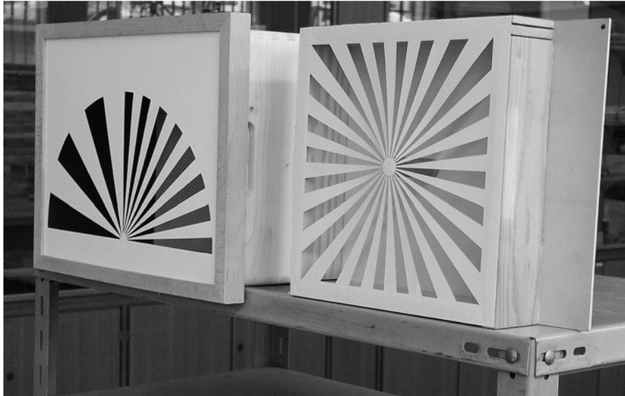
Abb. 4: BÖHLER-Sterne zur Bestimmung des Auflösungsvermögens. Links: Viertelkreise mit  $\gamma=15^\circ$  und  $6^\circ$ ,  $b=176\text{mm}$ ; rechts: Vollkreis mit  $\gamma=7,5^\circ$ ,  $b=62\text{mm}$
