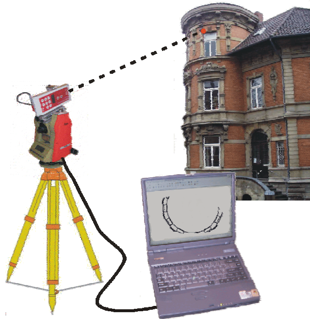
Abb. 2: Meßaufbau bei der reflektorlosen Polaraufnahme mit DISTO, T460D und Notebook
